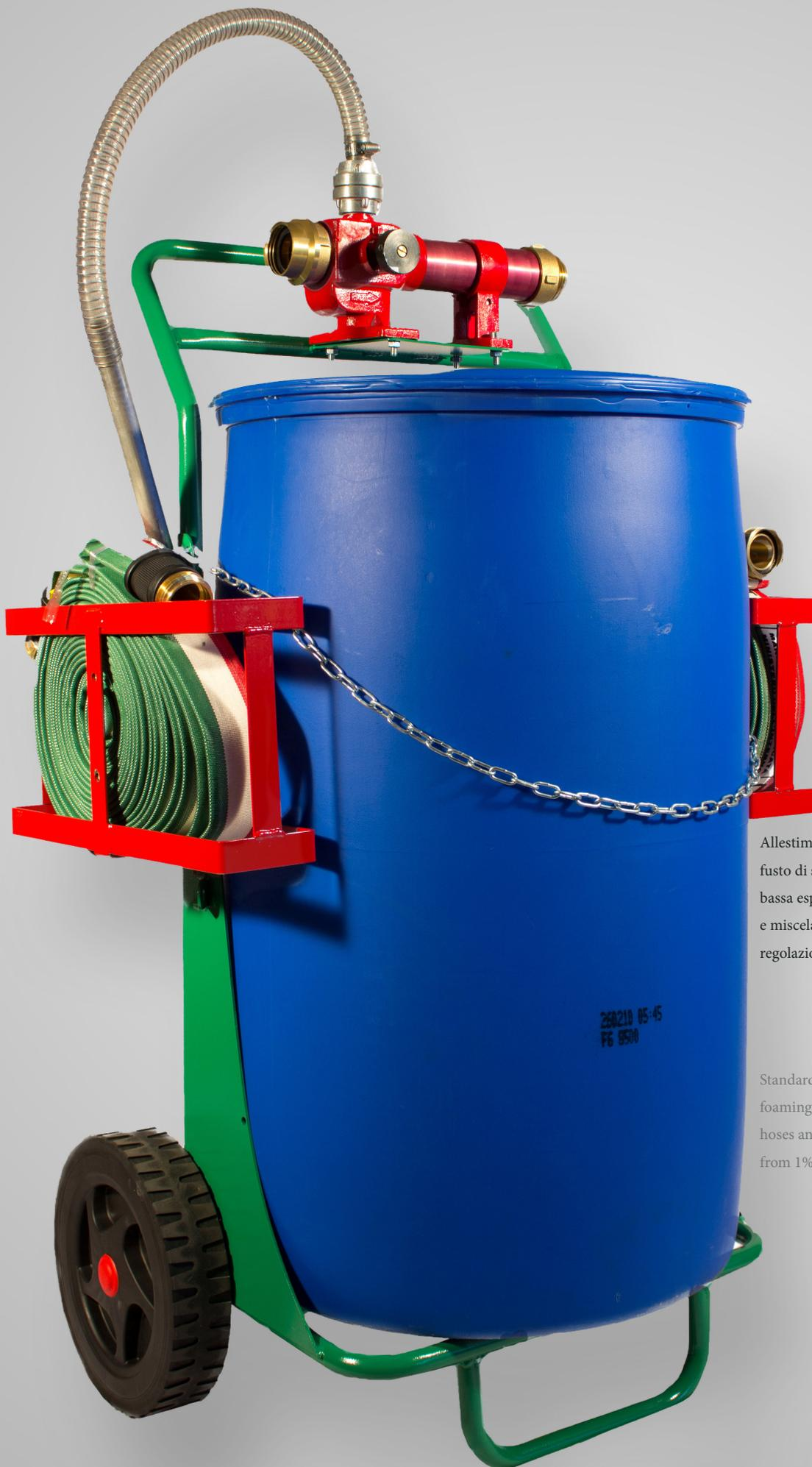
Allestimento standard completo di carrello, fusto di schiumogeno, lancia schiuma a bassa espansione, due manichette da 20 m e miscelatore variabile con possibilità di regolazione da 1% a 6%
