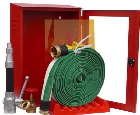
Il sistema è composto da: Cassetta da esterno/interno in lamiera verniciata, lastra frangibile, dichiarazione di conformità CE, rubinetto DN 45 PN 16, tubazione flessibile DN 45 a norma EN 14540 con raccordi e legatura a norma, sella salva manichetta, lancia antincendio UNI 45 a tre effetti.
